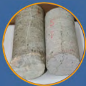
Penetron testigo de la capacidad de sellado de las grietas
